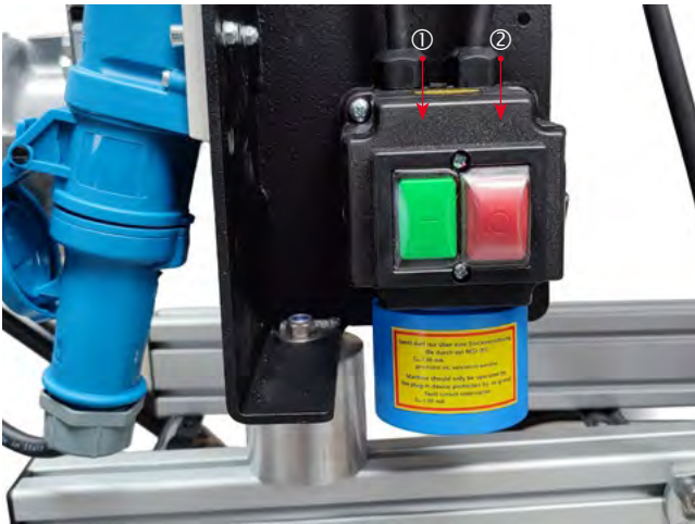
Elektroarmatur mit grünem Drucktaster zum Einschalten (1) und rotem Drucktaster zum Ausschalten (2) der Maschine
