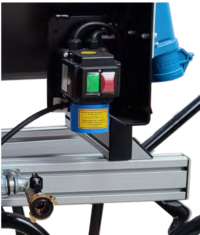
Anschluss Wechselstrom (230 V) und externer Wasseranschluss zum Reinigen der Maschine.
